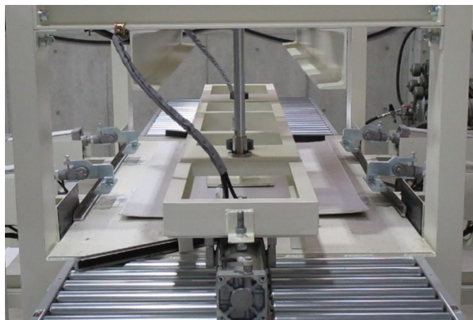
油圧式フレーム外し機 (未来創造(株)製)
