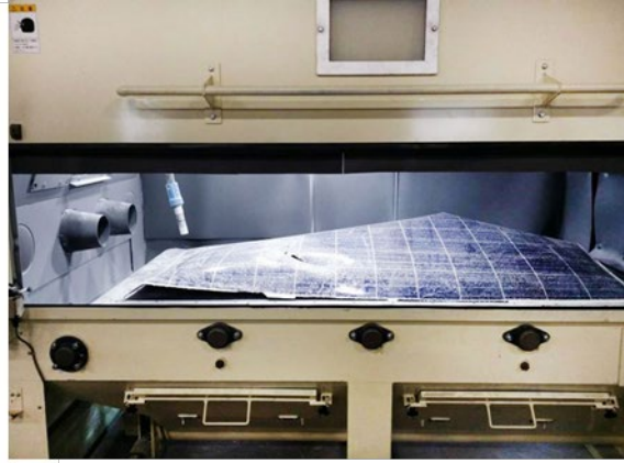
手動式カバーガラス剥離装置（未来創造㈱製）
