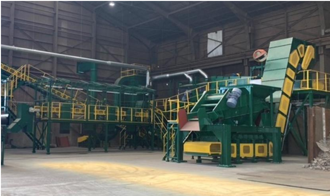
RV 船橋事業所 せん断後ダスト選別ライン
