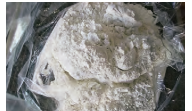
■廃液から抽出したリンによる肥料製造
