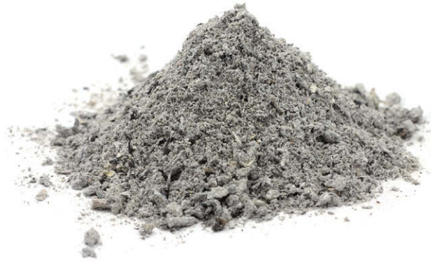
廃棄物を燃やして出る焼却灰は、埋立廃棄物量の多くを占めている
