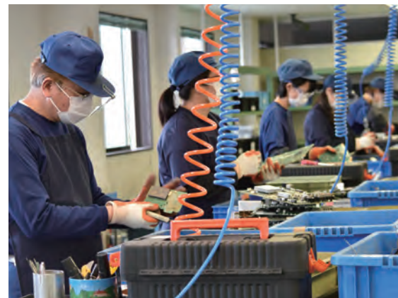
中田屋(株)熊谷工場での手解体の様子
