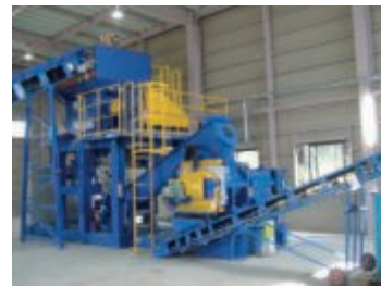
富士車輛(株)(RPF製造設備)
