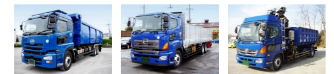
15tダンプ車 ダンプアップすることにより、シュレッダーダスト等の荷下ろしがスムーズ。 15t平ボディ車 荷台の側面が開閉するため、フォークリフト等による積下ろしが可能。 8tヒアブ車 グラッパ付きクレーンにより他車や自車への荷物の積み込みが可能。
