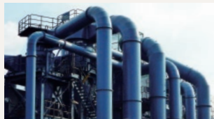
写真は集塵装置。他に排水処理施設、放射能探知機、フロン回収機などがある
