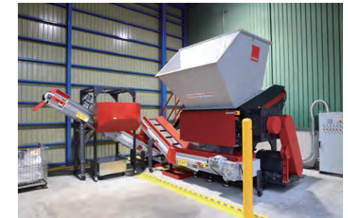
破碎・磁力選別ライン(リバーELV川島事業所)
